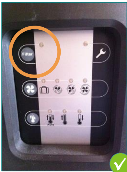
1 : Alarme de filtres identifiée par « Filter »
